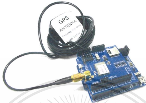
รูปที่ 3.3 การเชื่อมต่อ GPS Shield กับ Arduino
