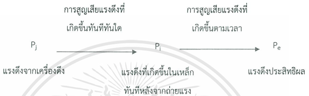
รูปที่ 2.11 การเสื่อมลดของแรงดึงในเหล็กเสริมอัดแรง
