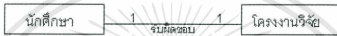
รูปที่ 2.31 ความสัมพันธ์แบบหนึ่งต่อหนึ่ง ( One - to - One Relationship )
