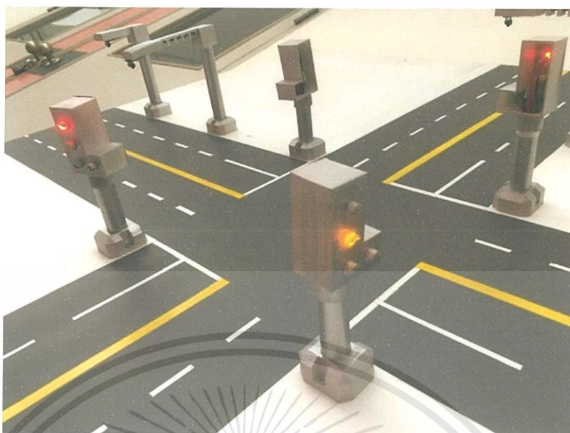
รูปที่ 4.5 การทำงานของระบบสัญญาณไฟจราจรรูปปกติ หลังจากครบ 45 วินาที จะเปลี่ยนเป็นไฟเหลือง 3 วินาที
