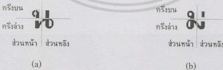
รูปที่ 3.6 แสดงลักษณะการขาด 2 ส่วน โดยมีการเหลื่อมล้ำของ Character Frame
