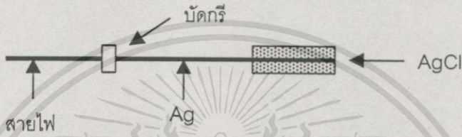
รูปที่ 4.2 ตำแหน่งการเชื่อมต่อระหว่างสายไฟฟ้ากับลวด Ag/AgCl
