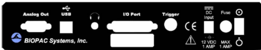
รูปที่ 3.13 แสดงภาพด้านหลังของอุปกรณ์วัดและบันทึกข้อมูล Biopac รุ่น MP 36 [29]
