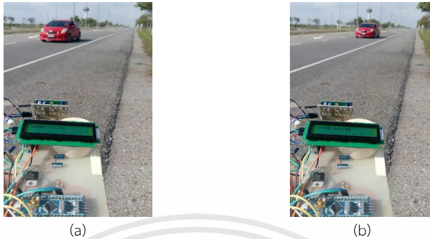
รูปที่ 4.22 ผลลัพธ์การวัดค่าความเร็วรถยนต์ที่ความเร็วจริง 90 กิโลเมตร/ชั่วโมง
