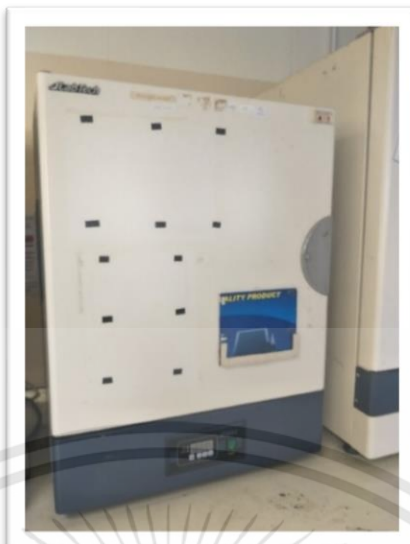
รูปที่ 4.6 ตู้อบความร้อน: WTB Binding, Germany อุณหภูมิสูงสุด 150 องศาเซลเซียส
