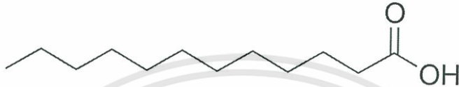
รูปที่ 2.29 แสดงสูตรโครงสร้างทั่วไปของสารคู่ควกรดลอริก (lauric acid; C_{12}H_{24}O_2 ) [30]
