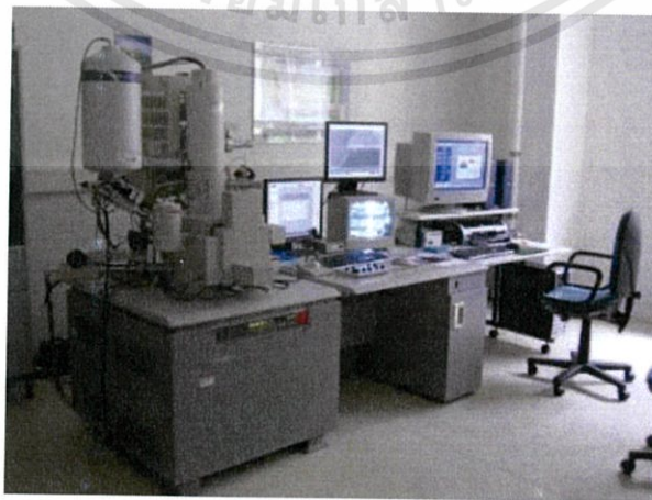
รูปที่ 3.7 กล้องจุลทรรศน์อิเล็กตรอนแบบส่องกราด (scanning electron microscope; SEM) [38]
