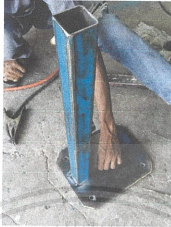
รูปที่ 3.25 แสดงการเชื่อมฐานกับท่อเหล็ก
