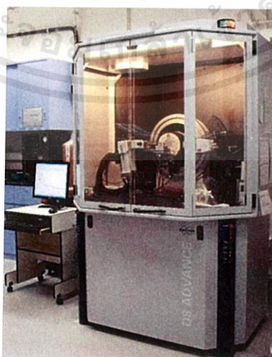
รูปที่ 2.8 เครื่องมือวิเคราะห์การเลี้ยวเบนรังสีเอกซ์
