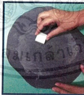
รูปที่ 3.3 ขั้นตอนการขีดพลาสติกชนิด ABS ด้วยกระดาษทรายและผงเพชร
