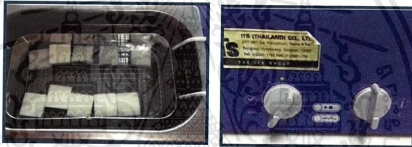
รูปที่ 3.5 ขั้นตอนการล้างพื้นผิวด้วย เครื่องอัลตราโซนิก
