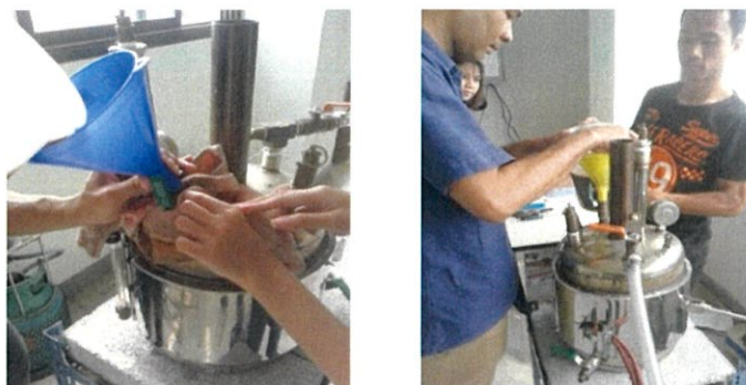
รูปที่ 3.14 แสดงการเติมน้ำหมัก นำน้ำหมักที่กรองแล้วมาเติมลงในหม้อต้ม
