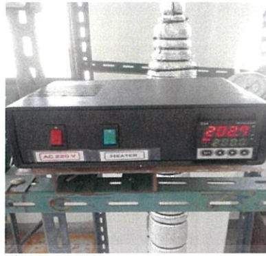
รูปที่ 3.17 กล่องควบคุมอุณหภูมิหม้อต้ม เปิดสวิตซ์เพื่อให้ Heater ทำความร้อนให้กับหม้อต้ม(ระบบพร้อมทำการกลั่น)สามารถปรับอุณหภูมิของหม้อต้มโดย Temp control ได้ตามเงื่อนไขที่ทำการทดลอง
