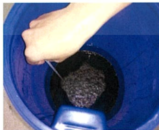
รูปที่ 3.6 แสดงการวัดอุณหภูมิสารละลาย นำเทอร์โมมิเตอร์มาวัดอุณหภูมิของสารละลายให้มีอุณหภูมิของสารละลายอยู่ที่ 30-35 °C จึงจะสามารถเทหัวเชื้อหรือยีสต์ที่เตรียมไว้ลงในสารละลายได้
