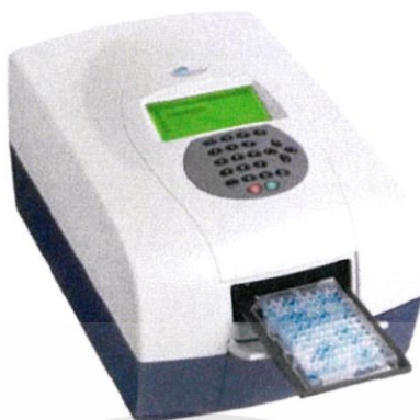
รูปที่ ข.6 เครื่อง microplate reader ยี่ห้อ Biochrom Anthos รุ่น Multiread 4000 (ที่มา : AZoQuantum.com)
