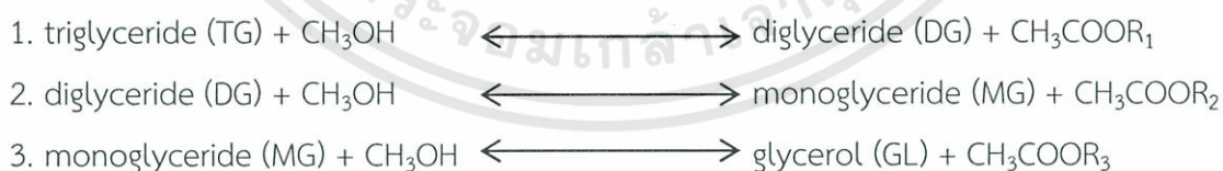
รูปที่ 2.10 กลไกปฏิกิริยาทรานเอสเทอร์ฟิเคชันระหว่างน้ำมันพืชกับแอลกอฮอล์
