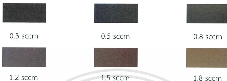
รูปที่ 4.17 ภาพถ่ายฟิล์มบางของสารกึ่งตัวนำคอปเปอร์ออกไซด์ที่เคลือบลงบนแผ่นฐานรองรับที่เป็นแผ่นกระจกสไลด์ ซึ่งเตรียมโดยวิธีการรีแอคทีฟดีซีแมกนีตรอนสเปตเตอริง ที่อัตราการไหลของออกซิเจน 0.3, 0.5, 0.8, 1.2, 1.5 และ 1.8 ลูกบาศก์เซนติเมตรต่อนาที
