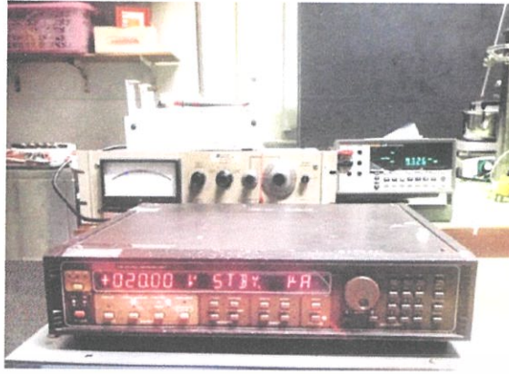
รูปที่ 3.19 ภาพถ่ายอุปกรณ์ที่ใช้วัดปรากฏการณ์ฮอลล์
