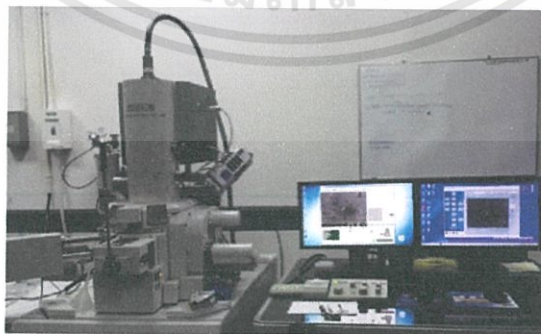
รูปที่ 3.14 ภาพถ่ายเครื่อง Field Emission Scanning Electron Microscope (FESEM) รุ่น JSM-7001F
