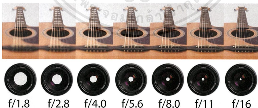
รูปที่ 2.19 การเปิดรูรับแสงที่มีผลต่อระดับความชัดภาพ
