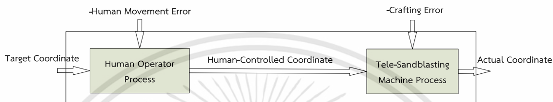
รูปที่ 1.4 แผนภาพแสดงองค์ประกอบของระบบพ่นทรายระยะไกลและแหล่งความผันแปรด้านพิกัดในระบบ
