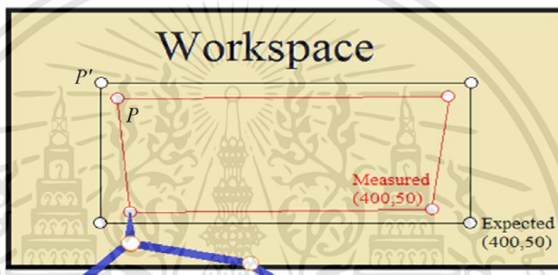
รูปที่ 2.13 พื้นที่การทำงานที่ผิดเพี้ยนเนื่องจากขนาดของชิ้นส่วนหุ่นยนต์ที่คลาดเคลื่อน
