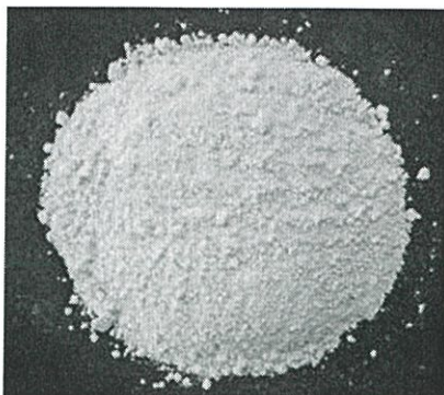
รูปที่ 2.4 ลักษณะทางกายภาพของเซอร์โคเนียมไดออกไซด์ [9]
