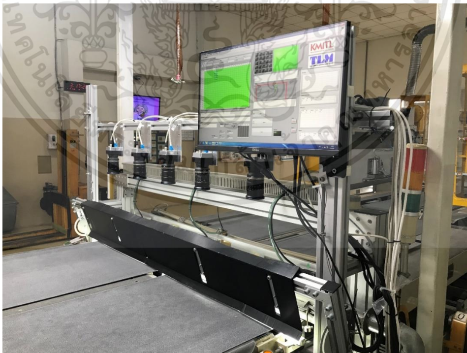
รูปที่ 3.4 ระบบตรวจวัดที่ถูกติดตั้งบนสายพานการผลิต
