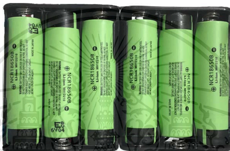
รูปที่ 3.8 แพคแบตเตอรี่ขนาดความจุ 12.6 โวลต์
