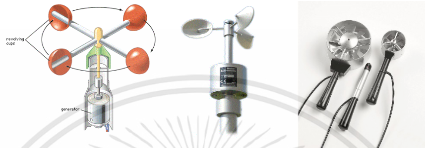
รูปที่ 3.14 มาตรฐานความเร็วแบบต่างๆ (แหล่งที่มา: มนตรี พิรุณเกษร [78])
