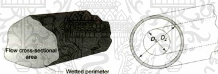
รูปที่ 3.23 เส้นผ่านศูนย์กลางเทียบเท่าของพื้นที่ตัดขวางไม่ใช่รูปทรงเรขาคณิตและแบบท่อซ้อน (แหล่งที่มา: ฐานิตย์ เมธิยานนท์ [79])
