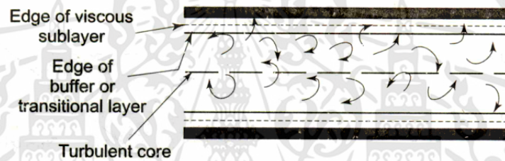
รูปที่ 3.25 รูปแบบของการไหลของของไหลสำหรับการไหลแบบปั่นป่วนภายในท่อ (แหล่งที่มา: ฐานิตย์ เมธียานนท์ [79])
