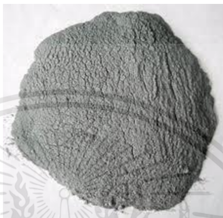
รูปที่ 3.2 ตัวอย่างปูนซีเมนต์พอร์ตแลนด์ประเภทที่ 1 ที่ใช้ในการวิจัย
