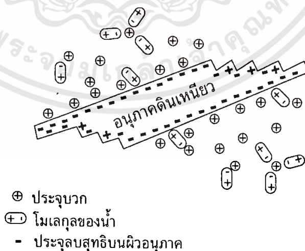
รูปที่ 2.11 แสดงอนุภาคของดินเหนียวในสภาพสารละลาย
