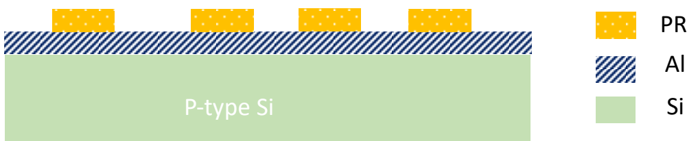
รูปที่ 3.4 ภาพจำลองการเคลือบสารไวแสงเพื่อสร้างขั้วโลหะนำไฟฟ้า
