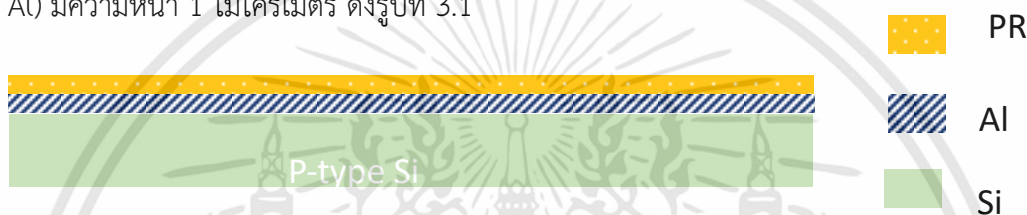
รูปที่ 3.2 ภาพจำลองการเคลือบน้ำยาไวแสงบนชั้นอะลูมิเนียม
