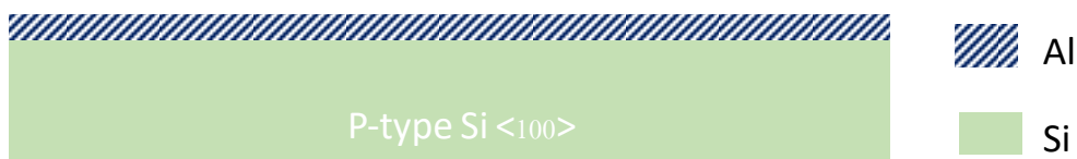
รูปที่ 3.1 ภาพจำลองการสร้างชั้นอะลูมิเนียมบนฐานรองซิลิคอนชนิดพี
