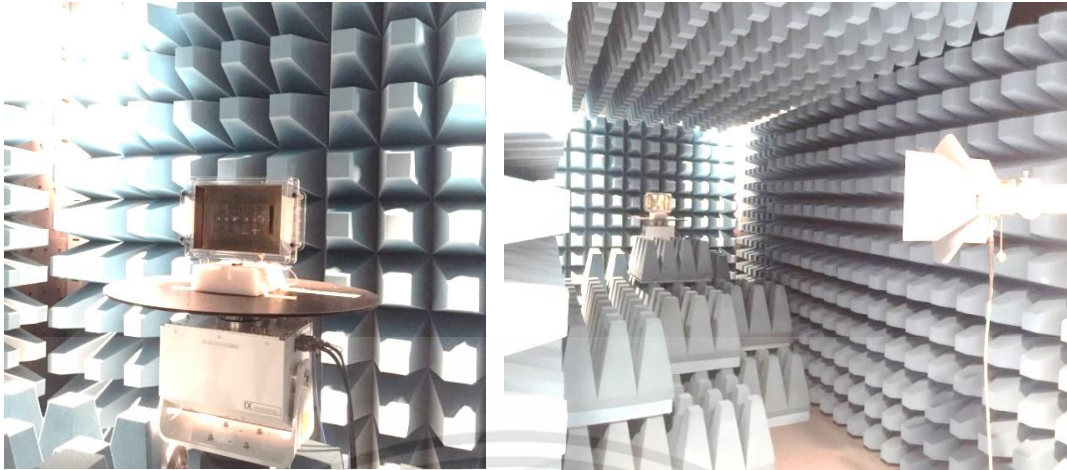
รูปที่ 5.5 สายอากาศไดโพลระนาบแบบสามความถี่วัดคุณลักษณะของสายอากาศในห้อง anechoic chamber
