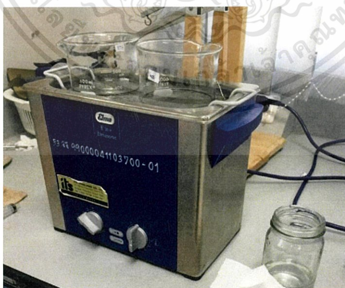
รูปที่ 3.10 แสดงการทำความสะอาดบนเครื่องทำความสะอาดความถี่อัลตราโซนิก
