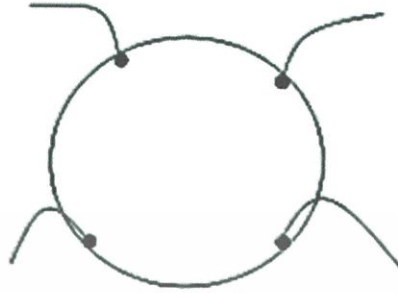
รูปที่ 2.13 ตำแหน่งของจุดสัมผัสบนชั้นสารตัวอย่างเพื่อวัดความต้านทานแผ่นและสภาพต้านทานไฟฟ้าด้วยเทคนิคแวนเดอร์เพาว์
