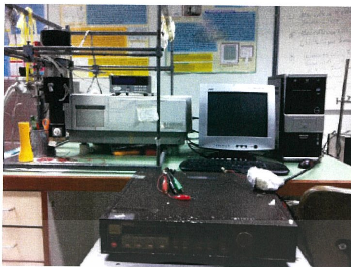
รูปที่ 3.3 อุปกรณ์ที่ใช้ในการศึกษาความสัมพันธ์ระหว่างค่ากระแสไฟฟ้า - แรงดันไฟฟ้า (I-V curve) ที่อุณหภูมิต่างๆ ของฟิล์มบางของสารกึ่งตัวนำ (\text{CdS})_{1-x}(\text{ZnTe})_x โดยวิธีการระเหยสารเคมีด้วยความร้อนในระบบสุญญากาศ
