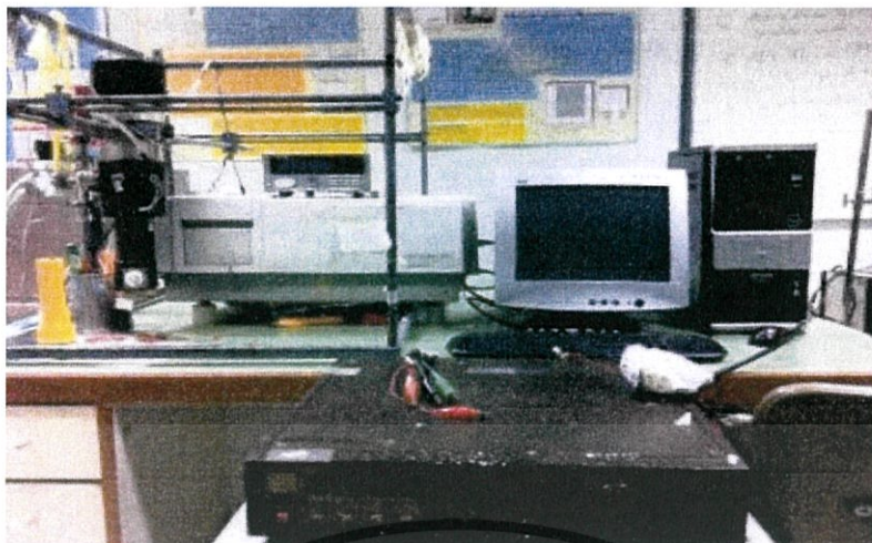
รูปที่ 3.10 แสดงอุปกรณ์ที่ใช้ศึกษาความสัมพันธ์ระหว่างค่ากระแสไฟฟ้า-แรงดันไฟฟ้า ที่อุณหภูมิ ต่างๆของไดโอดที่มีรอยต่อแบบวิวิธพันธุ์ของฟิล์มบางของสารกึ่งตัวนำ p\text{-SnS}/n\text{-WO}_3 : \text{Sb} ซึ่งเตรียมโดยวิธีการระเหยสารเคมีด้วยความร้อนในระบบสุญญากาศ
