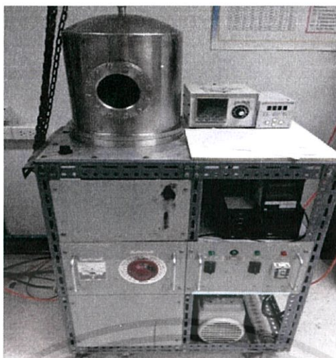
รูปที่ 3.8 แสดงอุปกรณ์ที่ใช้ในการเตรียมไดโอดของสารกึ่งตัวนำ p-SnS/n-WO 3 :Sb ตามลำดับโดยการเคลือบฟิล์มบางของสารกึ่งตัวนำ SnS ลงบนแผ่นฐานรองรับที่เป็นกระจกสไลด์และที่เป็นเม็ดเซรามิกของสารกึ่งตัวนำ W 1-x Sb x O 3 (x=0.05) โดยวิธีการระเหยสารเคมีด้วยความร้อนในระบบสุญญากาศโดยการให้อุณหภูมิแก่แผ่นฐานรองรับประมาณ 100 องศาเซลเซียส
