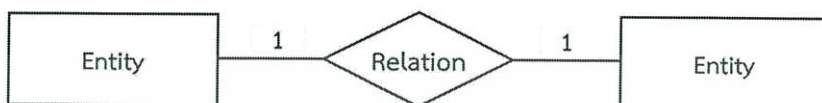
รูปที่ 2.8 ความสัมพันธ์ของเอนทิตีแบบหนึ่งต่อหนึ่ง
