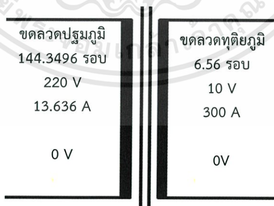
รูปที่ 3.6 ไดอะแกรมของโครงสร้างหม้อแปลงไฟฟ้าที่ทำการออกแบบสร้าง
