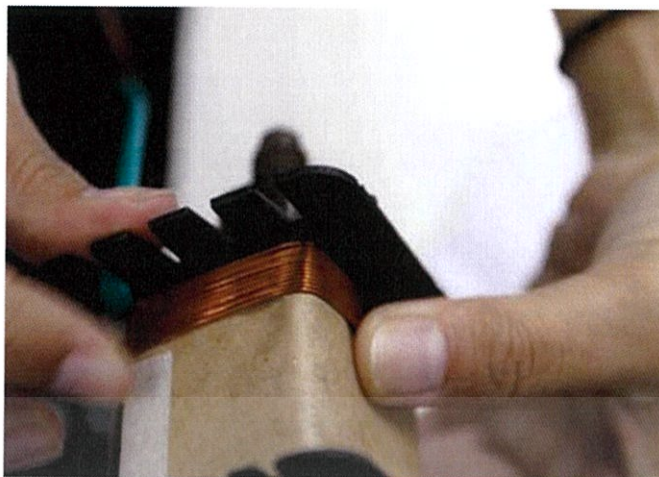
รูปที่ 2.9 ฆนวนที่พันอยู่บนขดลวดตัวนำ [9]
