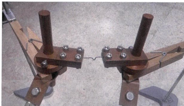
รูปที่ 3.25 แหล่งกำเนิดการระเหยสารแบบรอยหยักต่อเข้ากับขั้วสำหรับระเหยสาร
