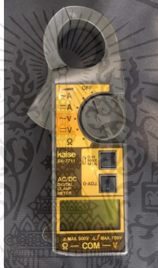
รูปที่ 3.20 Clamp meter
