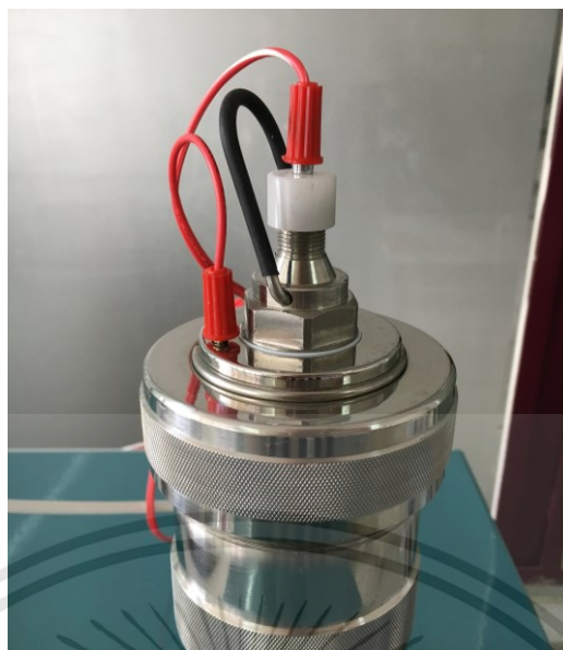
รูปที่ 3.12 ลูกบอมบ์ที่เสียบสายจลุดระเบิดแล้ว
