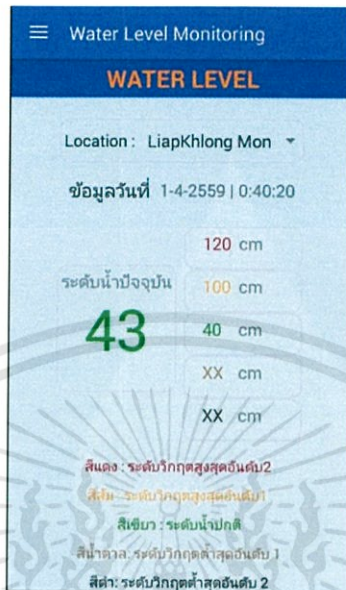
รูปที่ 3.16 หน้าจอแสดงค่าระดับน้ำปัจจุบัน
