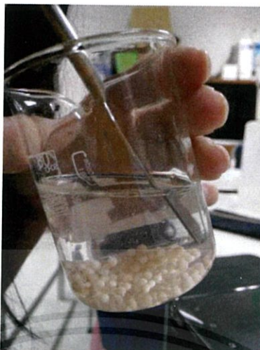
รูปที่ 4.8 ภาพถ่ายแสดงลักษณะทางกายภาพของวัสดุประกอบ MMT-KNO 3 /CS ในสารละลาย STPP ก่อนการอบแห้ง
