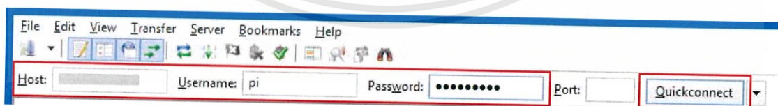
รูปที่ ก.2 กรอกรายละเอียดสำหรับเชื่อมต่อ Raspberry Pi
