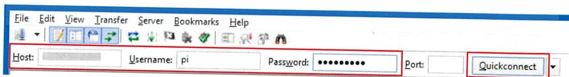
รูปที่ ข.2 กรอกรายละเอียดสำหรับเชื่อมต่อ Raspberry Pi
