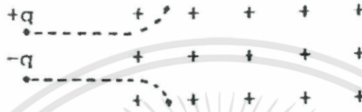
รูปที่ 2.19 ประจุต่างชนิดกันเคลื่อนที่ในทิศทางเดียวกันผ่านสนามแม่เหล็กที่ตั้งฉากกับทิศทางของการเคลื่อนที่ของประจุทั้งสอง [15]
