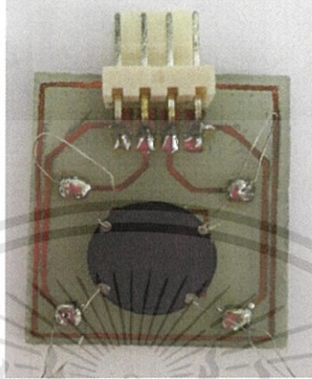
รูปที่ 4.30 สารตัวอย่าง \text{CuAl}_{0.9}\text{Fe}_{0.1}\text{O}_2 ที่ติดลงบน Sample board ด้วย Silver paint contact
