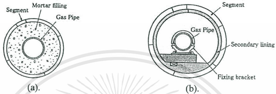
รูปที่ 3.10. แสดงรูปตัดอุโมงค์วางท่อก๊าซ (a).ประเภทเติมมอร์ต้า (b).ประเภทอุโมงค์การตรวจสอบ
