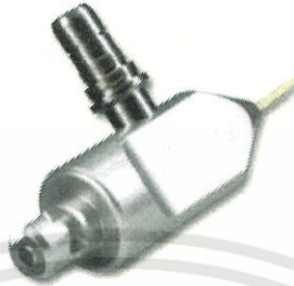
รูปที่ 3.2 ภาพหัวเชื่อมต่อของมัลติแคว้นำแสง probe ที่แยกช่องแสงที่ใช้กระตุ้นกับแสงที่ถูกปล่อยหรือสะท้อนกลับมา
