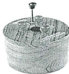
รูปที่ 4.1 แคลอริมิเตอร์ไฟฟ้า (Electric Calorimeter)
