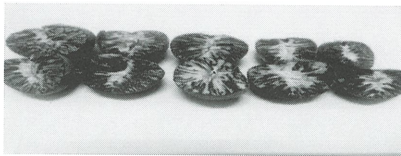
ภาพที่ 4.11 เนื้อหมากหลังอบแห้งที่อุณหภูมิ 100°C และที่ความเร็วรอบตะแกรง 6 rev/min
