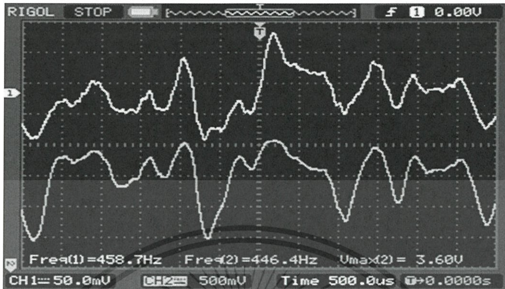
รูปที่ 4.1 รูปแสดงสัญญาณเสียงที่วัดได้โดยประกอบด้วย สัญญาณเสียงที่วัดได้จากภาคส่งสัญญาณ (Channel1) และสัญญาณเสียงที่วัดได้จากภาครับสัญญาณ(Channel2) ที่ระยะ 30cm เมื่อมีแสงจากหลอดไฟในห้องรบกวน
