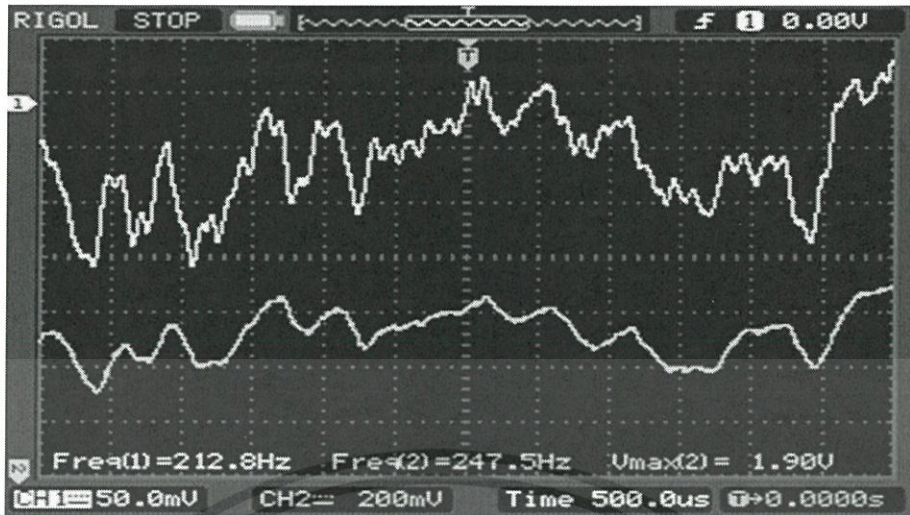
รูปที่ 4.3 รูปแสดงสัญญาณเสียงที่วัดได้โดยประกอบด้วย สัญญาณเสียงที่วัดได้จากภาคส่งสัญญาณ (Channel1) และสัญญาณเสียงที่วัดได้จากภาครับสัญญาณ(Channel2) ที่ระยะ 1.5 m เมื่อมีแสงจากหลอดไฟในห้องรบกวน
