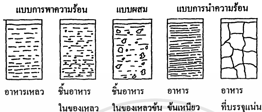
ภาพที่ 1 ลักษณะการส่งถ่ายความร้อนในผลิตภัณฑ์อาหาร
