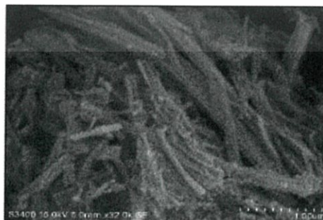
รูปที่ 4.9 ลักษณะพื้นผิวของท่อนาโนไททาเนต
