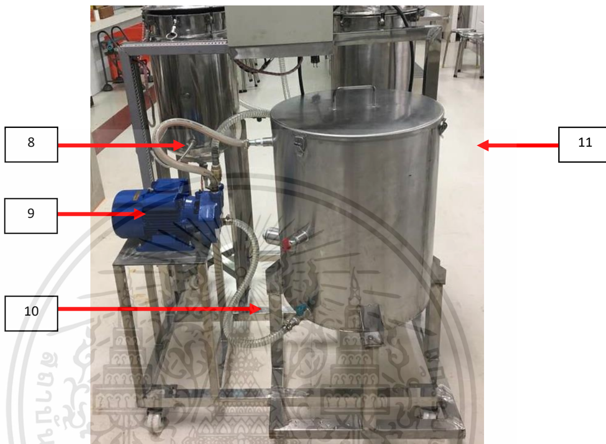
รูปที่ 2 ส่วนประกอบเครื่องแช่ฮีมสุญญากาศ (ด้านหลัง)
