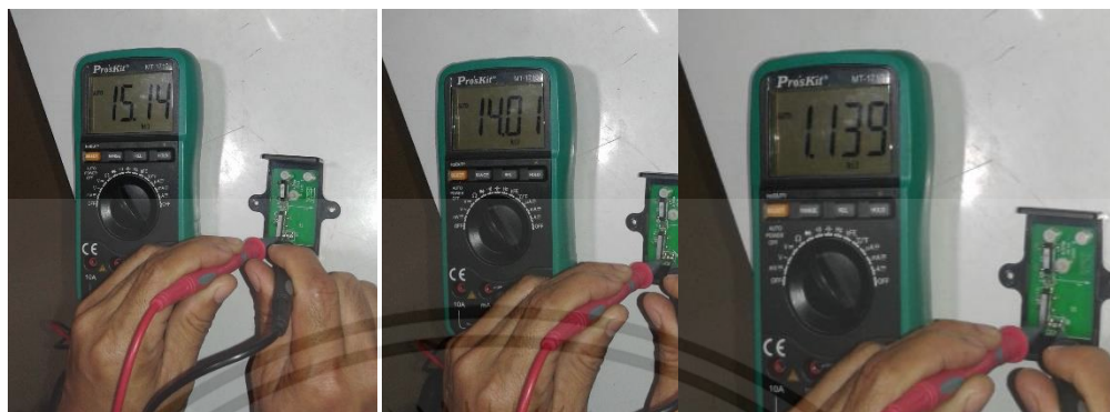
รูปที่ 3.29 การตรวจวัดค่าความต้านทานของ Hall Effect Sensor (ตัวที่ผิดปกติ)
