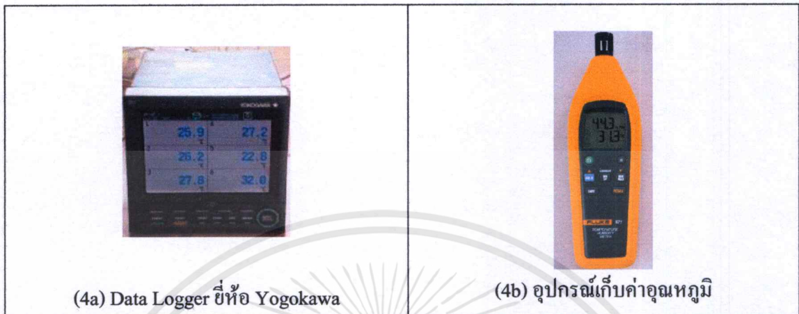
ภาพที่ 2.41 Data Logger ที่ใช้ในการบันทึกข้อมูลและอุปกรณ์เก็บค่าอุณหภูมิ
