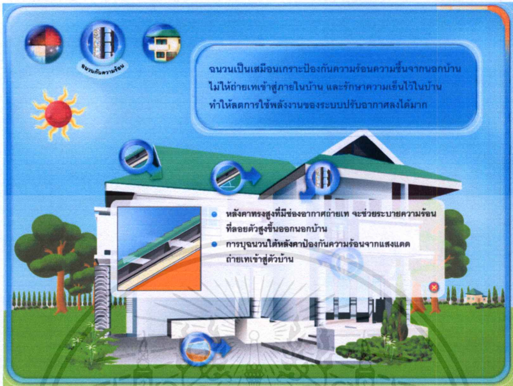
ภาพที่ 5.30 การติดตั้งฉนวนให้กับหลังคา
