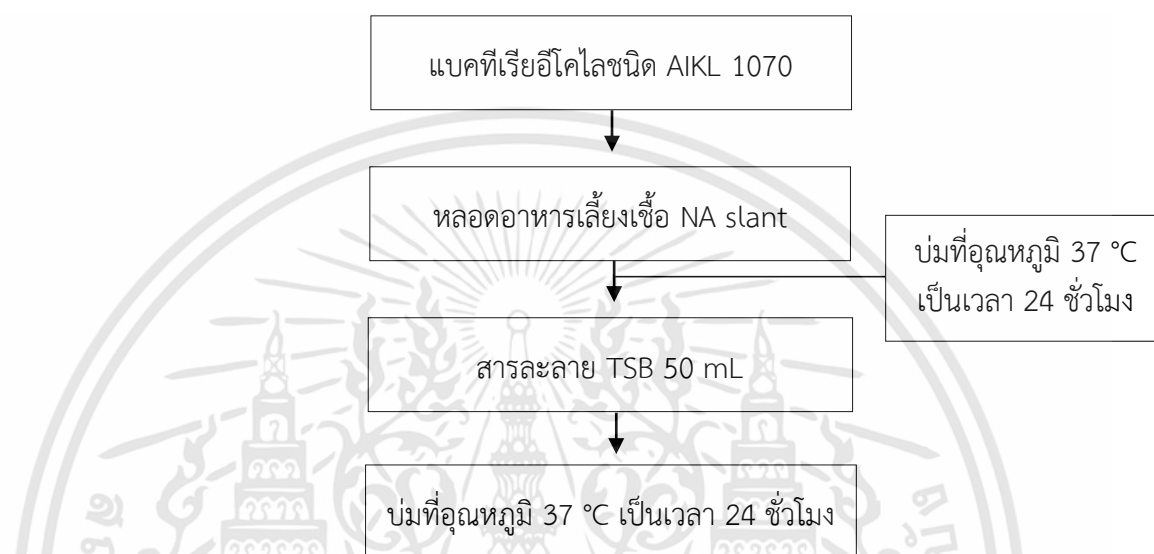
รูปที่ 3.21 ขั้นตอนการเตรียมสารละลายเชื้อแบคทีเรียอีโคไลสำหรับหยดลงบนชิ้นงาน
