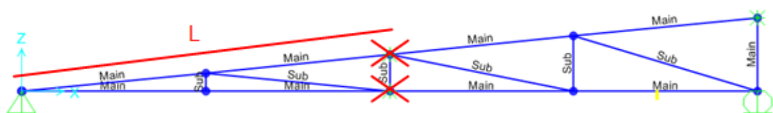
รูปที่ 3.12 โครงถัก Pitch และระยะ L
