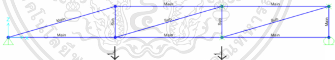
รูปที่ 3.24 โครงถัก Half hip และการให้น้ำหนักบรรทุกทุกคงที่ 1 KN
