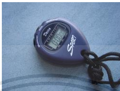
รูปที่ 4.5 นาฬิกาจับเวลาแบบทดเวลาหยุดชั่วขณะได้
